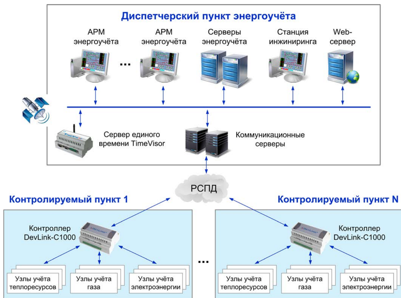
Типовая структурная схема ИАСКУЭ предприятия
