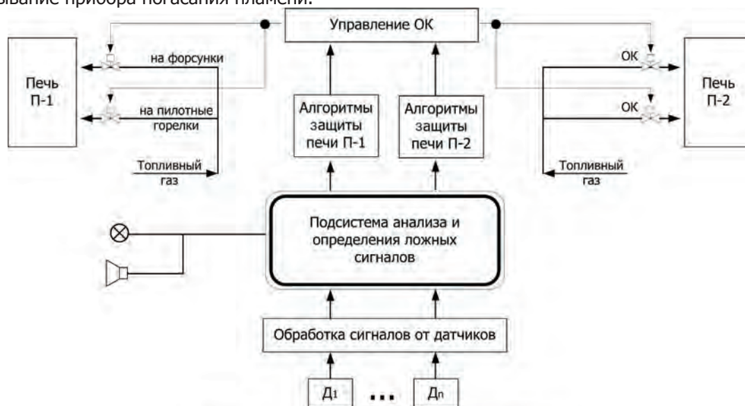
Схема усовершенствованной системы защиты печей (Д – датчик, ОК – остоичной клапан)
