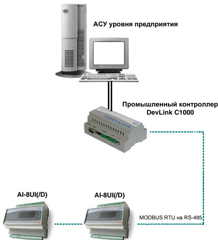
Модули серии DevLink-A10. обеспечивают периферийный ввод-вывод аналоговых и дискретных сигналов. Модули DevLink- A10. AI-8UI, AI-8UI/D входят в состав серии DevLink A10. и имеют 8 независимых каналов измерения аналоговых унифицированных сигналов напряжения и тока, осуществляют передачу данных в управляющий компьютер (контроллер).
