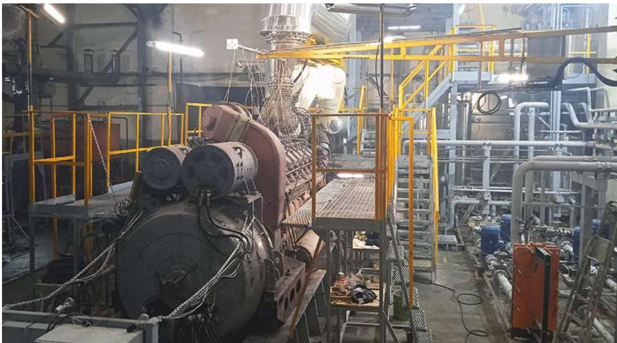
Разработан универсальный стенд для проведения обкатки, регулировки и испытаний дизельных двигателей. АСУ формирует управляющие сигналы и обеспечивает согласованное взаимодействие подсистем стенда с исполнительными механизмами.
