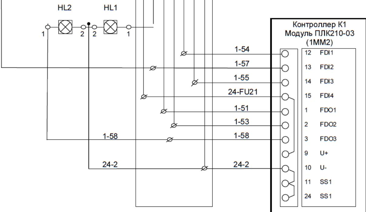
Рисунок 4.1.5 – Пример схемы резервирования процессорных модулей ОВЕН ПЛК210-03
