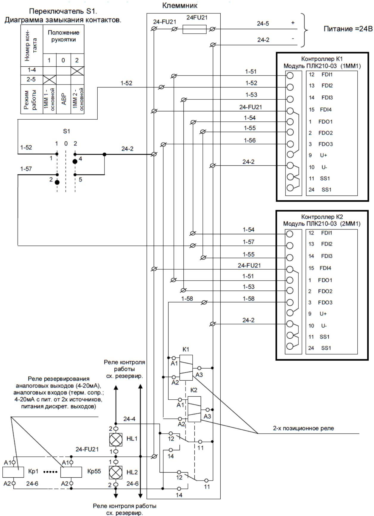
Рисунок 4.1.3 – Пример схемы 100% резервирования контроллеров ОВЕН ПЛК210-03
