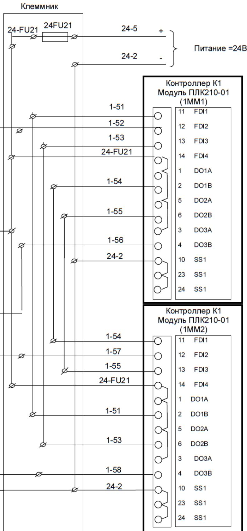
Рисунок 4.1.4 – Пример схемы резервирования процессорных модулей ОВЕН ПЛК210-01 (02, 04)
