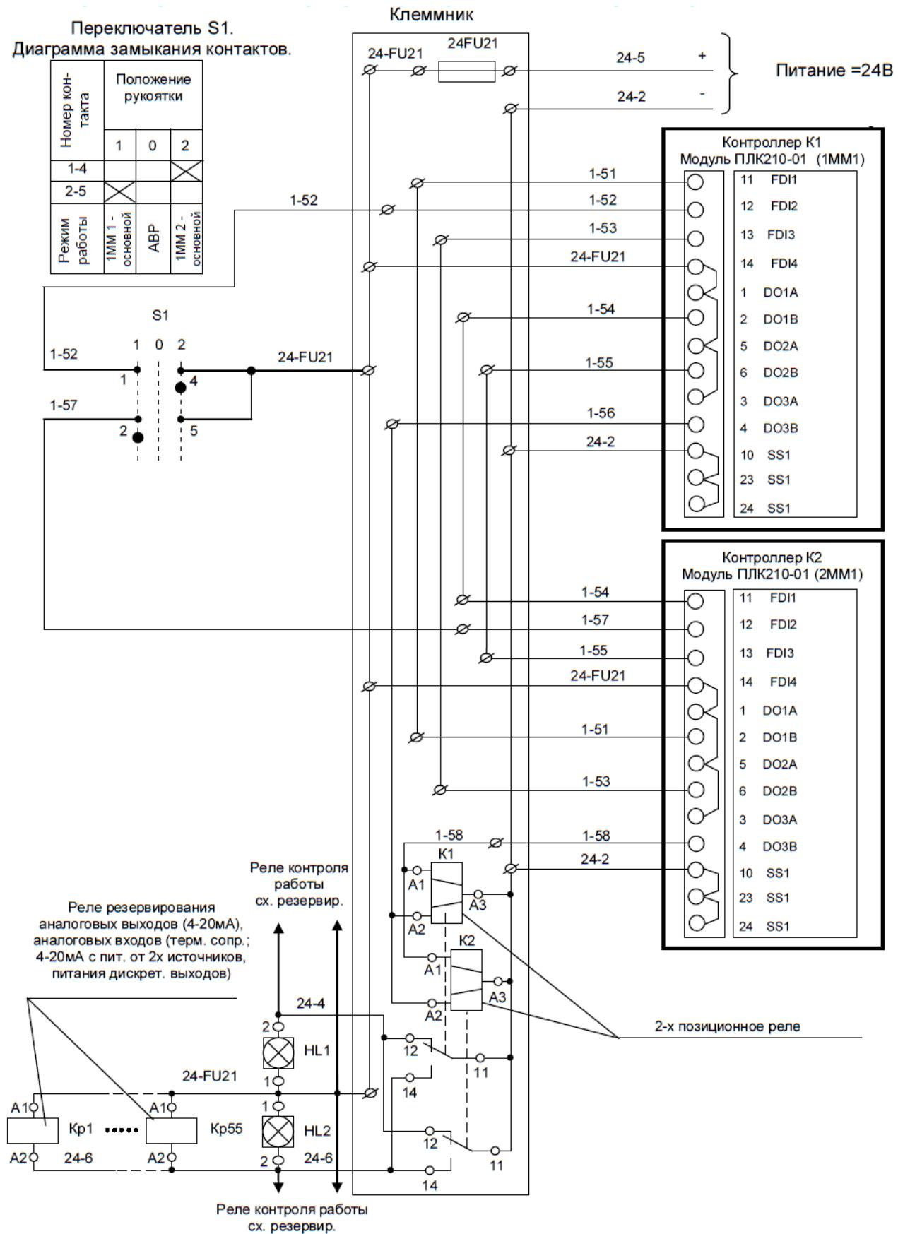
Рисунок 4.1.2 – Пример схемы 100% резервирования контроллеров ОВЕН ПЛК210-01(02, 04)
