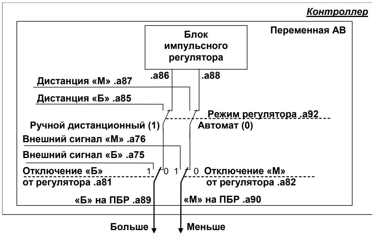
Рисунок А.12.1 - Блок-схема управления исполнительным механизмом
