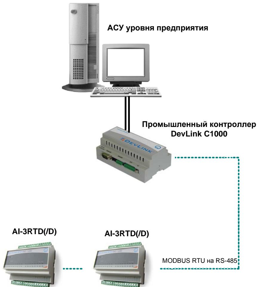
Модули входят в состав серии DevLink-A10 и имеют 3 независимых канала измерения аналоговых сигналов термопреобразователей сопротивления и потенциометрических датчиков, осуществляют передачу данных в управляющий компьютер (контроллер).
