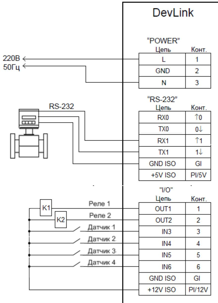
Рисунок П 1.1 - Пример подключения к DevLink® прибора с интерфейсом RS-232 (канал 1),
