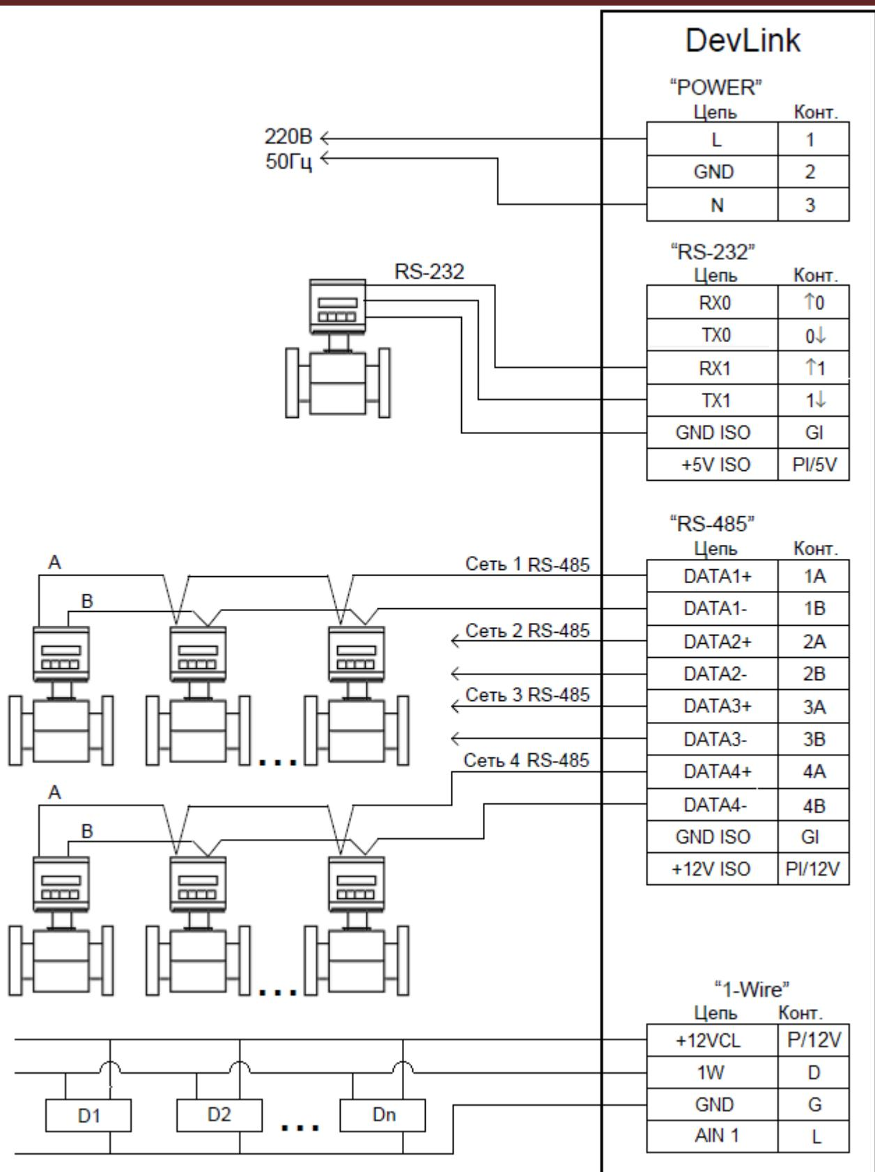
Рисунок П 1.2 - Пример подключения к **DevLink®** приборов с интерфейсами RS-232 (канал 0), RS485, OneWire
