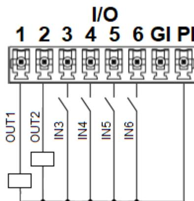
Рисунок 4 - Схема подключения к дискретным выходам DO и дискретным входам DI с использованием внутреннего источника питания
