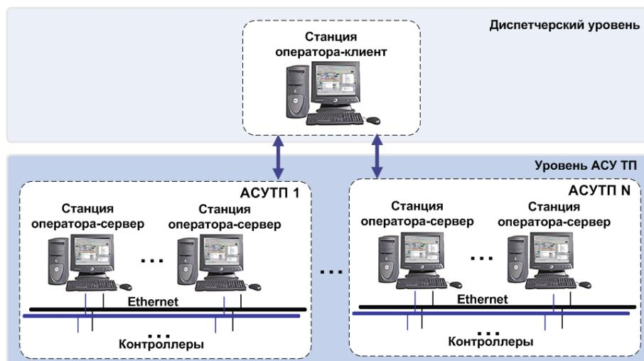
Рисунок 1.4.11 – Диспетчерское управление с использованием многосерверного доступа
