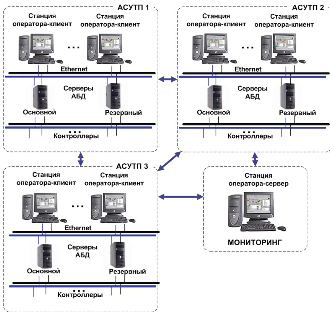
Рисунок 1.4.12 – Архитектура межсерверного обмена
