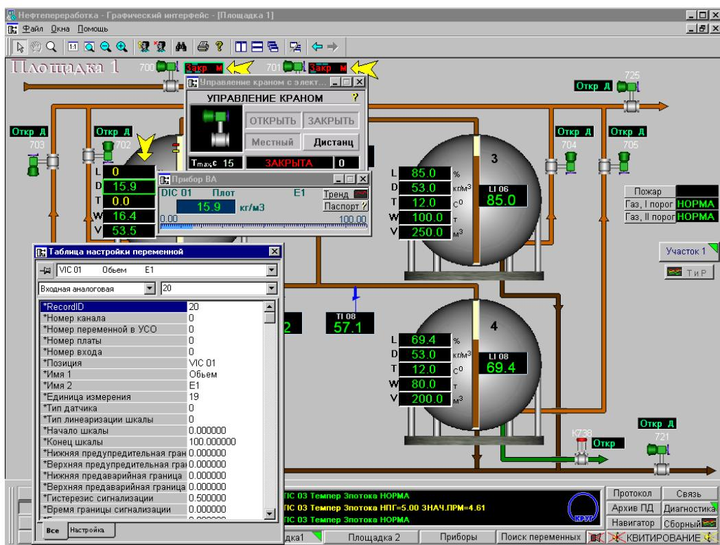
Рисунок 1.4.9 - Графический интерфейс Станции оператора
