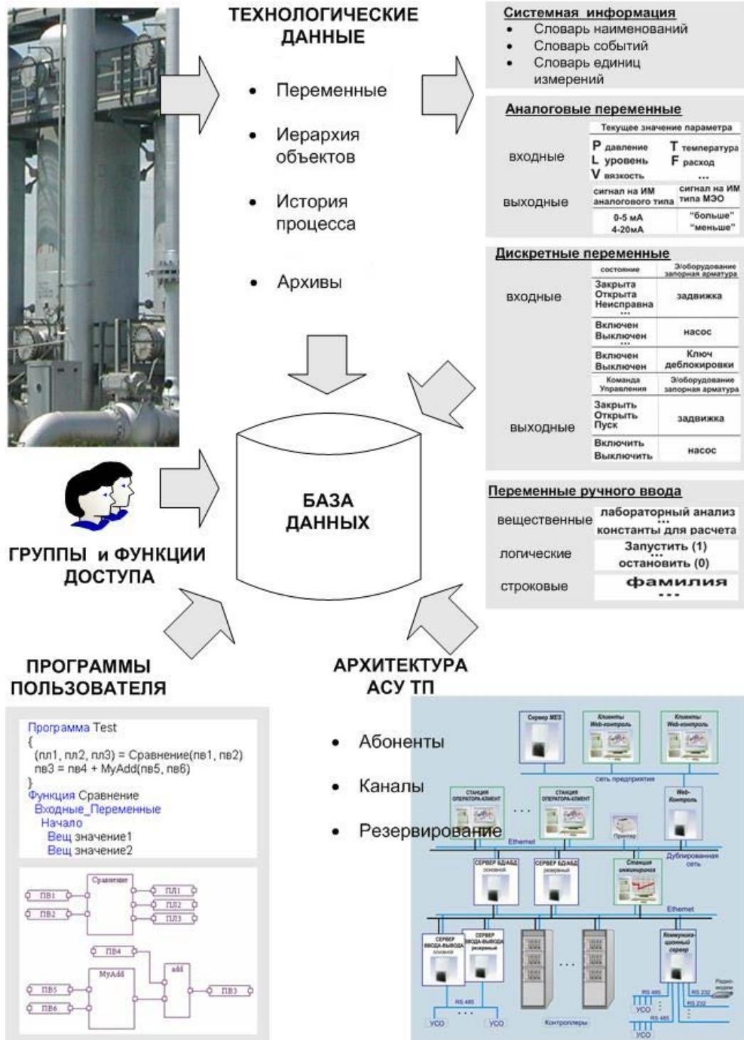
Рисунок 1.4.2 – Информационная структура базы данных SCADA КРУГ-2000
