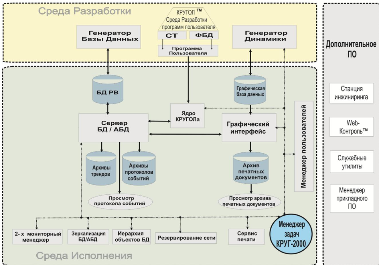
Рисунок 1.4.1 - Структурные компоненты ПО SCADA КРУГ-2000
