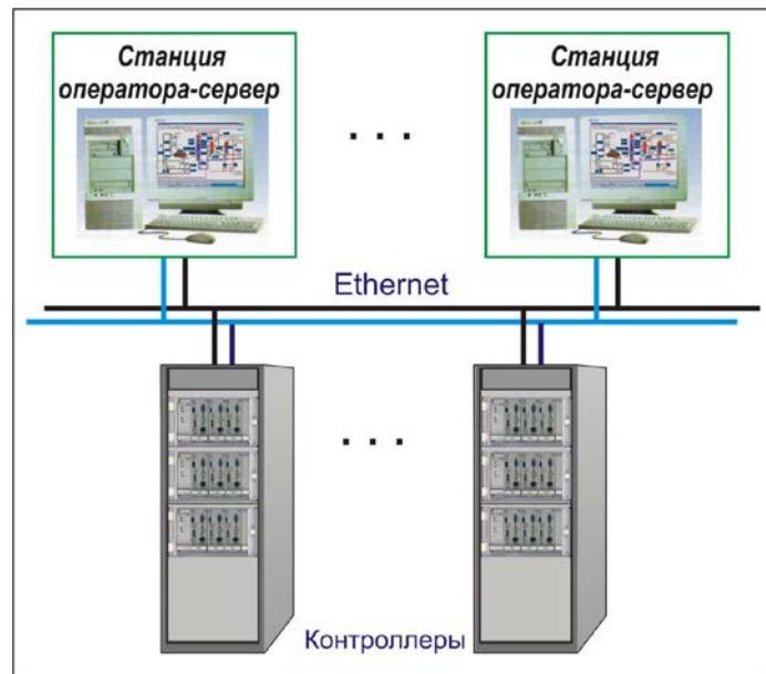
Рисунок 1.4.6 - Пример построения простой локальной АСУ ТП
