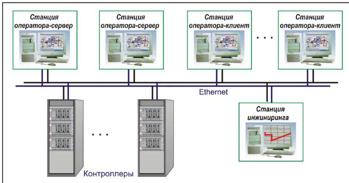
Рисунок 1.4.7 - Пример построения АСУ ТП с использованием архитектуры клиент-сервер
