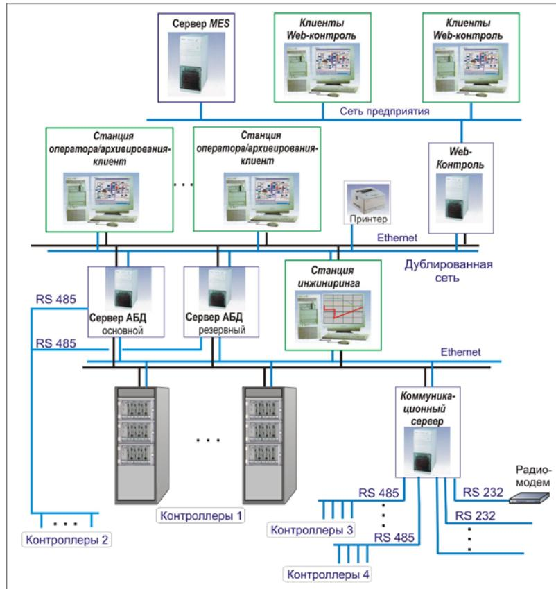
Рисунок 1.4.8 - Пример построения многоуровневой АСУ ТП с использованием архитектуры клиент-сервер и резервированием выделенных серверов
