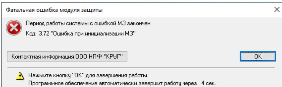
Рисунок 2.3.3 - Сообщение системы защиты об окончании периода завершения работы КРУГ-2000
