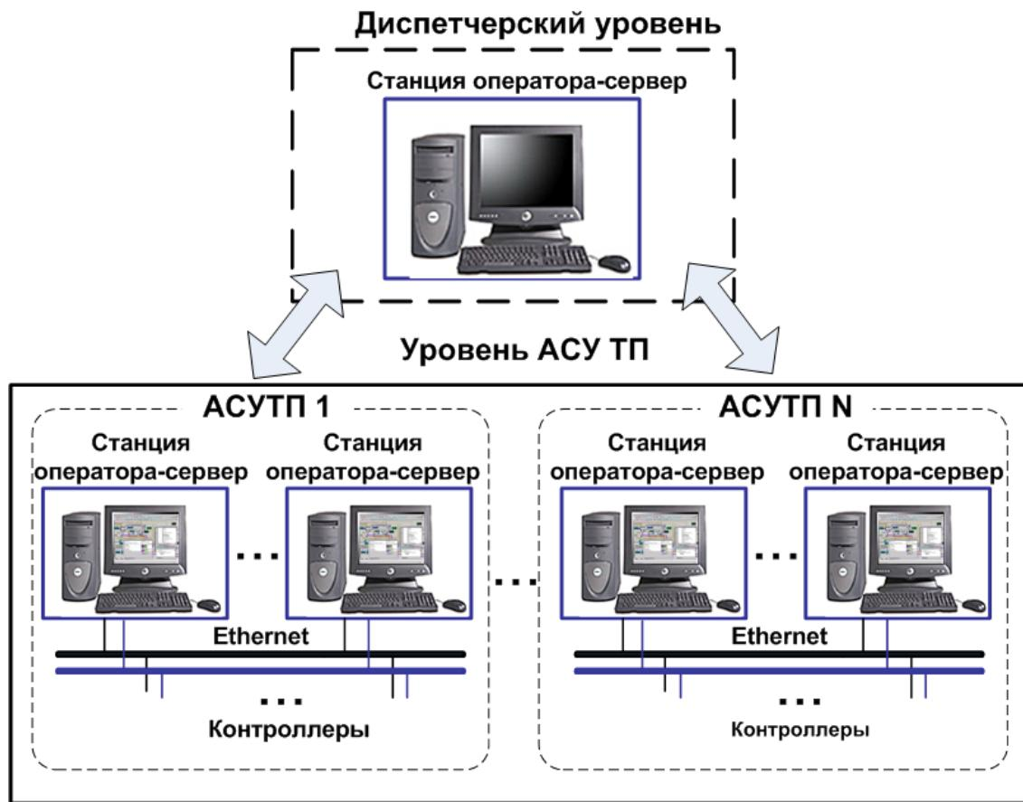
Рисунок 9.1.2 – Диспетчеризация и межсерверный обмен
