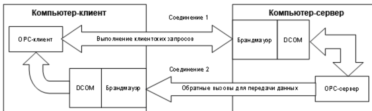
Рисунок 1.1 - Схема взаимодействия с OPC-сервером
